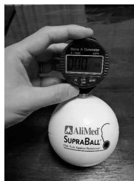
図3 硬度計での測定
